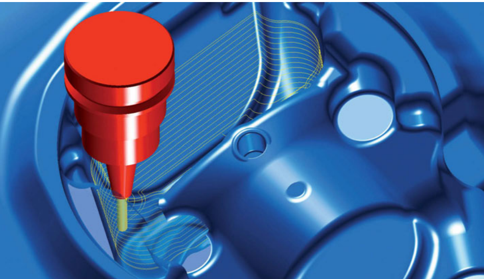
Innovative 5-Achs-Strategien beispielsweise für die Bearbeitung tiefer Kavitäten.
